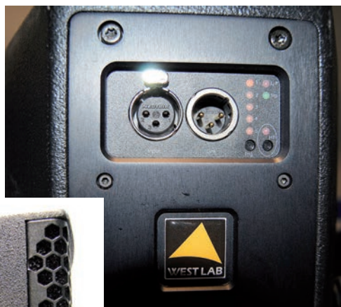
Das Aktivmodul der „Labtop Sixfive“ besitzt fünf abrufbare Presets und ein separates Low Cut-Filter
