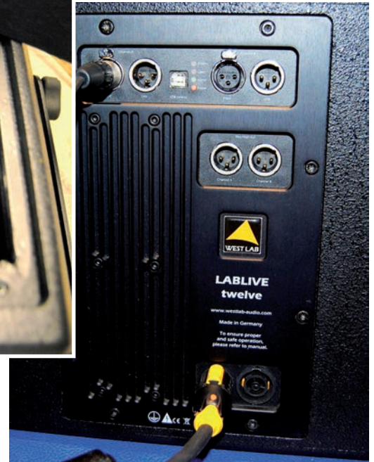
Der „Lablive Twelve“ Subwoofer besitzt keinerlei Bedienelemente – nur über die DSP Control Software lassen sich Veränderungen via USB-Schnittstelle vornehmen
